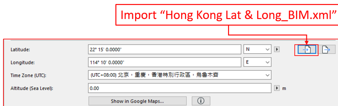
Figure 5 Importing XML file in Archicad 26 to set Latitude and Longitude
